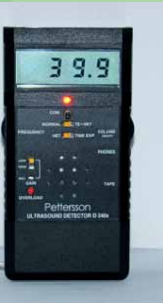
Profesionalni ultrazvučni detektor za slepe miševe sa time expansion i heterodyning sistemom
