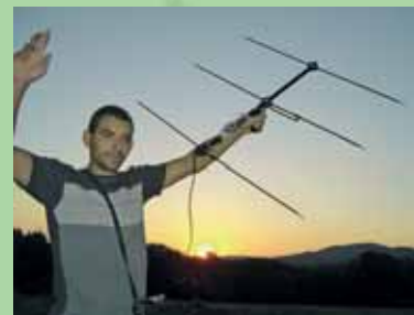
Direkciona antena omogućuje lociranje signala koji emituje radio-odašiljač
